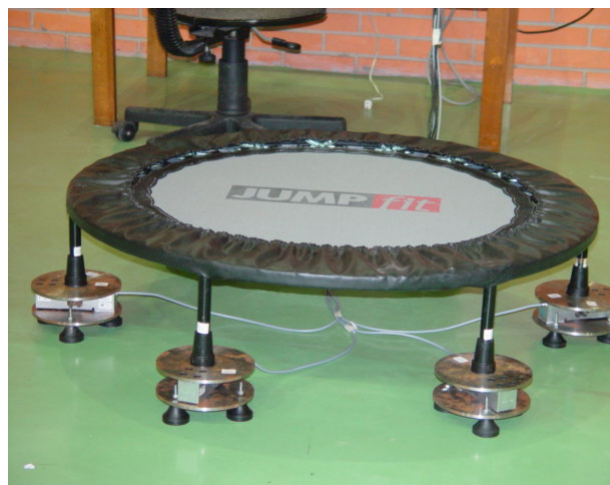
Figura 1: JUMP FIT® instrumentado com 6 células de carga.
