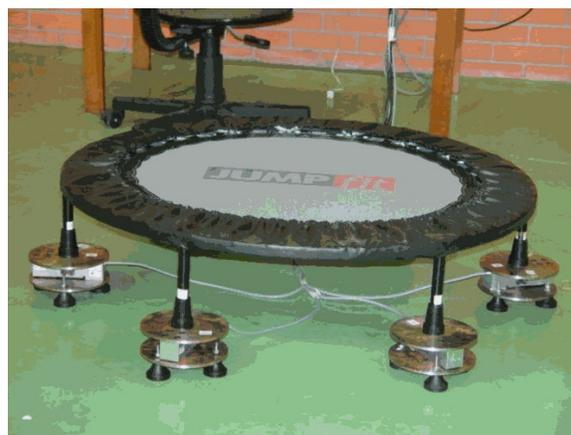
**Figura 1:** *Jump Fit* instrumentado com 6 células de carga.
