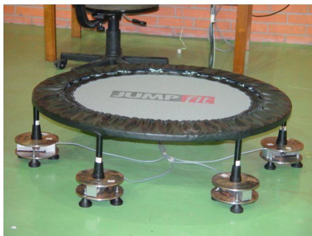
Figura 1: JUMP FIT ® instrumentado com 6 células de carga.
